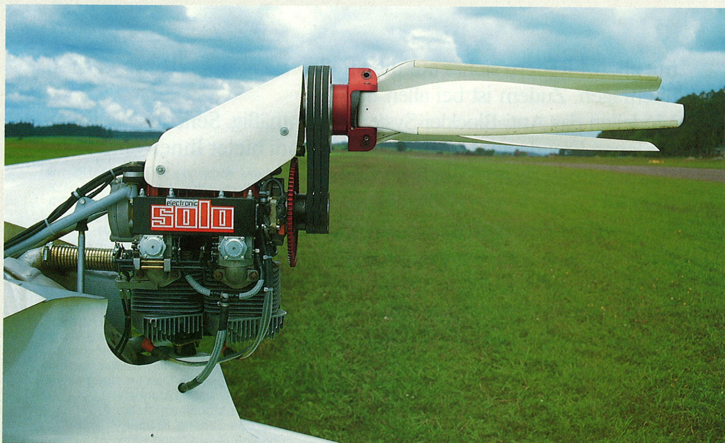
Bei abgestelltem Motor klappt der Propeller automatisch in Segelstellung (oben). Das linke Bild zeigt das Cockpit
